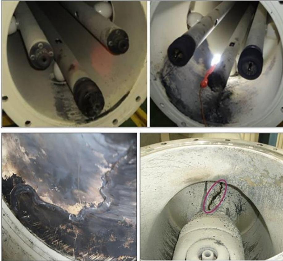
*Дефекты КРУЭ, верхний ряд: повреждение контактов, нижний: пробитие барьера КРУЭ из-за ухудшения изоляции*
