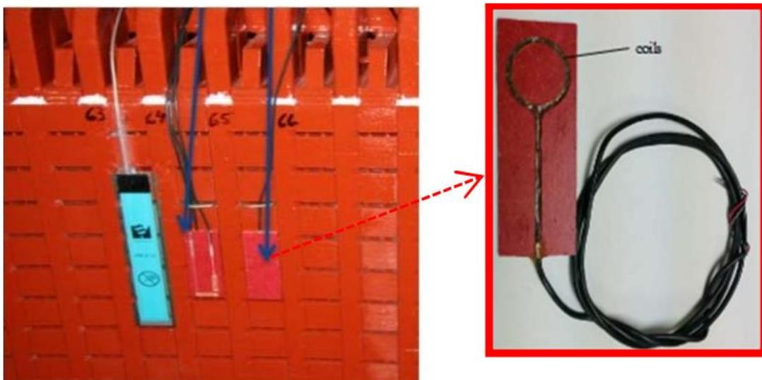
*Изготовленные датчики магнитного потока*
